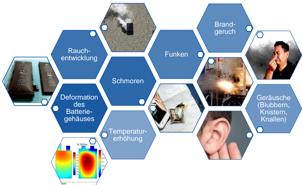
Abbildung 3: Allgemeine Anzeichen für einen beschädigten Akku, Quelle: Heck 2018, eigene Darstellung, Bildquellen: Internet
