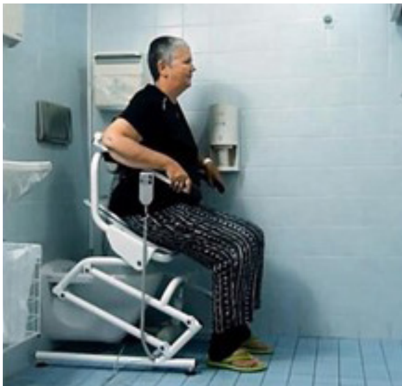
Abbildung 6: Die iToilet wurde in einem EU-Projekt an der TU Wien mitentwickelt. Sie unterstützt Benutzer durch anpassbare Einstellungen, Sprachinterfaces und automatische Notrufe. Quelle: TU Wien
