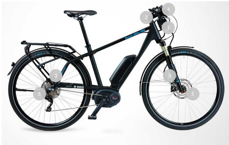
Abbildung 11: E-Bike mit ABS-System von Bosch mit Kontrolleinheit (1), Kontrollleuchte (2), Sensoren (3), Bremse (4). Quelle: https://www.bosch-ebike.com/de/produkte/abs/
