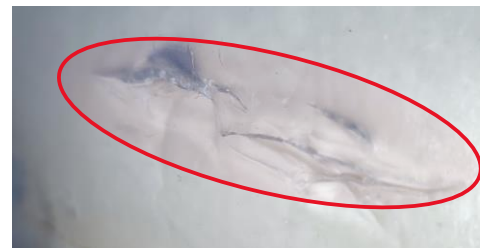
Abbildung 17: Test 9, durch Propeller verursachte Schnittverletzung an der Stirn
