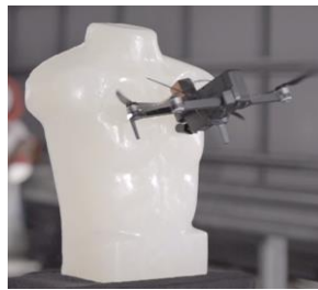
Abbildung 19: Test 10, Drohne beim Aufprall auf das Seifen-Torsomodell
