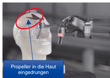
Abbildung 16: Test 9, Drohne beim Aufprall
