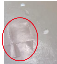
Abbildung 20: Test 10, Prellungen durch scharfe Kanten am Torsomodell
