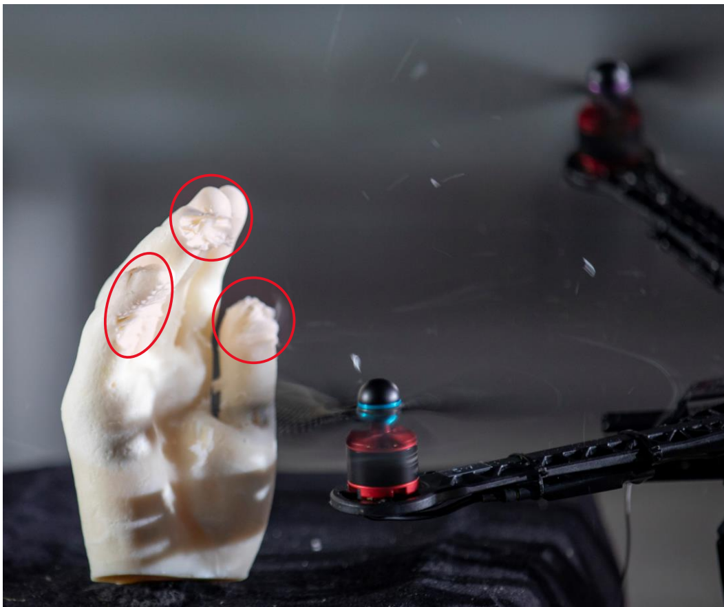
Abbildung 29: Test 14, Handverletzungen durch Carbon-Propeller
