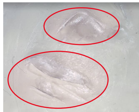
Abbildung 9: Test 6, Propellerschäden am Kopfmodell
