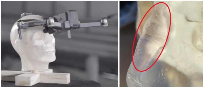
Abbildung 14: Test 8, Aufprall der Drohne, Auszug aus der Hochgeschwindigkeitsaufnahme (links) und angerichteter Schaden im Nasenbereich (rechts)
