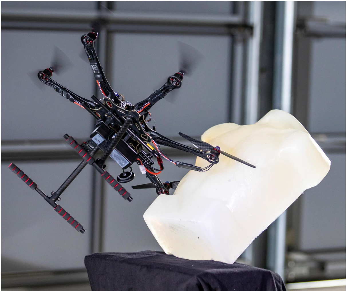
Abbildung 28: Test 13, das Torsomodell wird zu Boden geschleudert
