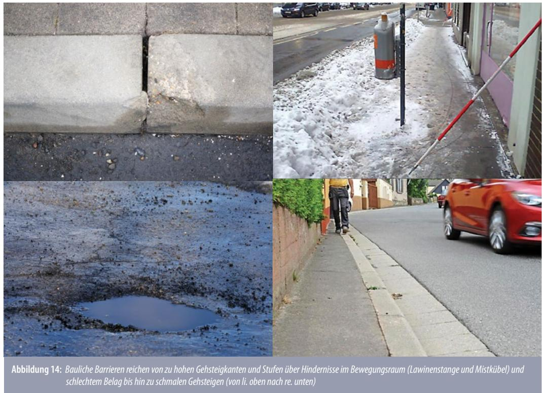
Abbildung 14: Bauliche Barrieren reichen von zu hohen Gehsteigkanten und Stufen über Hindernisse im Bewegungsraum (Lawinstange und Mistkübel) und schlechtem Belag bis hin zu schmalen Gehsteigen (von li. oben nach re. unten)
