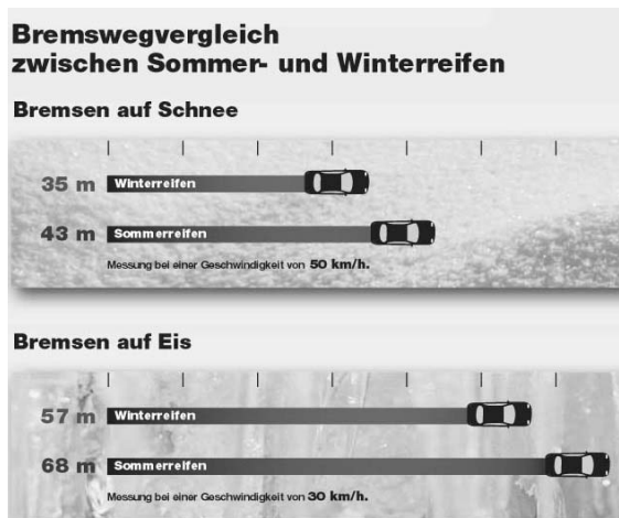
Abbildung 2: Bremsvergleich zwischen Sommer- und Winterreifen auf Schnee und Eis 1
