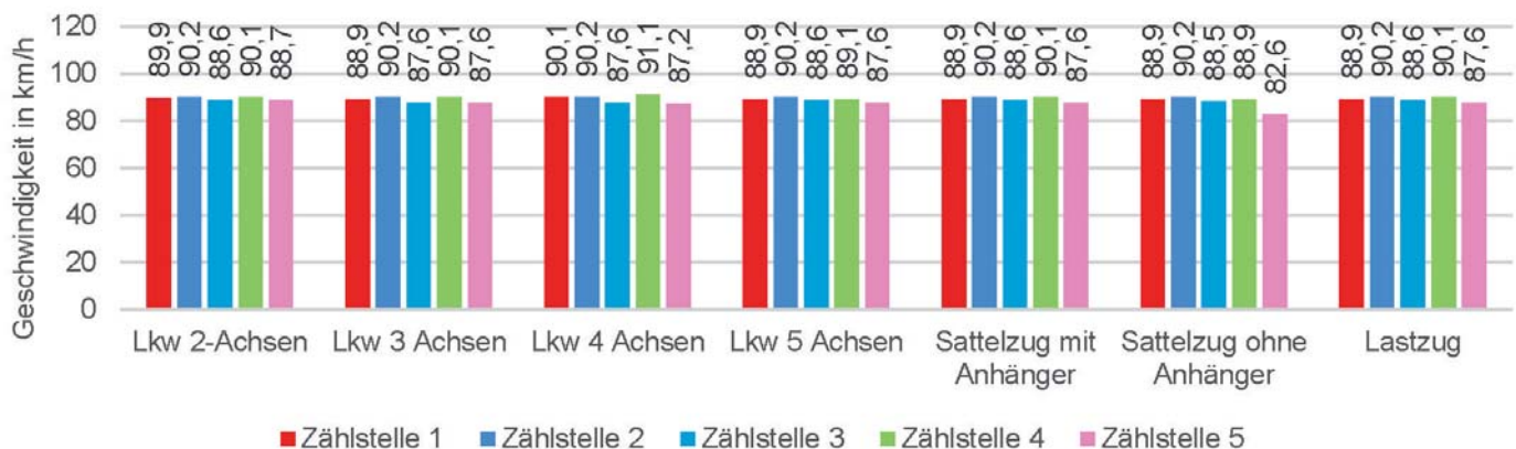
Abbildung 1: Lkw-Geschwindigkeiten (V 85 ) nach Lkw-Gewichtsklassen (in km/h) untergliedert nach Zählstellen – Zählstelle 1 (St. Florian), Zählstelle 2 (Dobl), Zählstelle 3 (Mannswörth), Zählstelle 4 (Hallein) und Zählstelle 5 (Wörgl). Quelle: eigene Erhebung
