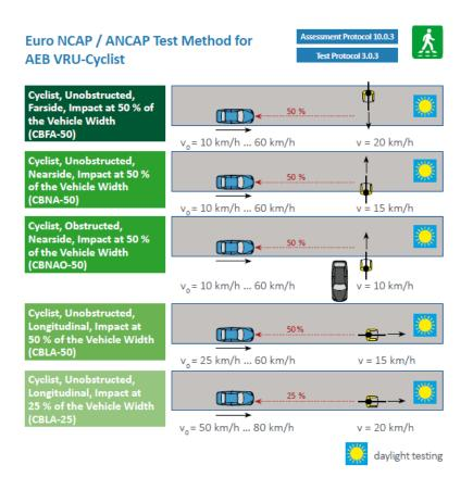
Abbildung 24: Testszenarien des Euro NCAP/ANCAP für Radfahrende (Quelle: carhs.training gmbh 2019)
