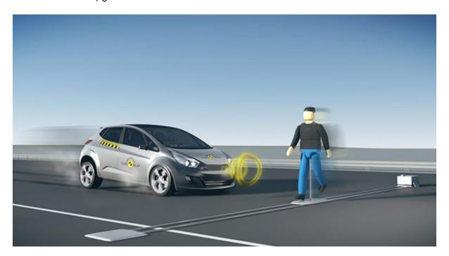
Abbildung 7: Illustration eines AEBS-Testszenarios zum Schutz von Fußgänger\*innen nach Euro NCAP (Quelle: Euro NCAP)
