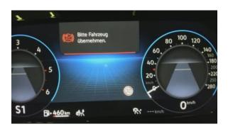
Abbildung 20: Fahrzeug nach Auslösung AEB, Bremsung und Warnung. (Quelle: CARISSMA)
