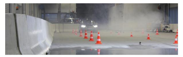
Abbildung 15: CARISSMA-Innenanlage während eines Fahrversuchs. Anmerkung: Im Vordergrund ist die regennasse Fahrbahn zu sehen. Ebenfalls zu erkennen ist die beginnende Vernebelung der Halle durch die Nebelanlage (Wasserpartikel). (Quelle: CARISSMA)
