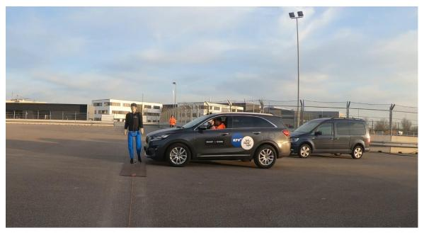
Abbildung 21: Testfahrzeug nach AEB-Aktivierung vor Adult-Dummy im CPNC-50-Versuch (Verdeckung durch 2 am Straßenrand abgestellte Fahrzeuge). Quelle: CARISSMA
