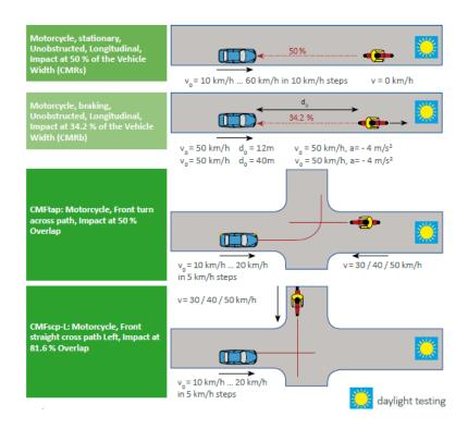
Abbildung 25: Testszenarien des Euro NCAP/ANCAP für motorisierte Zweiräder (Quelle: carhs.training gmbh 2019)
