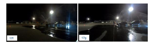
Abbildung 17 (a-g): Fahrzeug C, CPNC-50, 4activePA-adult, v\_Fzg 15 km/h, v\_Target 5 km/h, Dämmerung, Regen (5.5°C, 1.3 m/s Wind, 17 Lux), keine Triggerung der Sicherheitsfunktion. (Quelle: CARISSMA)
