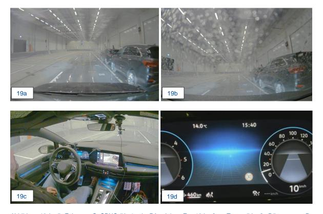
Abbildung 19 (a-d): Fahrzeug C, CPNC-50, 4activePA-adult, v\_Fzg 10 km/h, v\_Target 5 km/h, Dämmerung, Regen (16 mm/h), (22.4°C, 30 Lux), AEB ausgelöst/Fzg. gebremst & gewarnt. (Quelle: CARISSMA)
