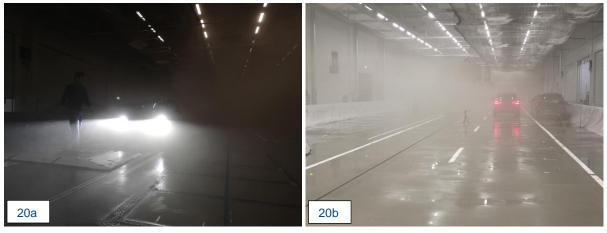
Abbildung 22 (a-b): Indoor-Tests unter widrigen Witterungsbedingungen. Links: Dämmerung bei Nebel. Rechts: regennasse Fahrbahn mit Nebel. (Quelle: CARISSMA)
