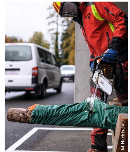
Die Schnittschutzhose schützt vor schweren Verletzungen mit der Motorsäge. Bei Kontakt mit der laufenden Sägekette werden größere Bündel der in der Hose eingearbeiteten langen Kunststofffasern herausgezogen, wickeln sich um das Antriebsrad der Kettensäge und blockieren dieses so in Bruchteilen von Sekunden.
