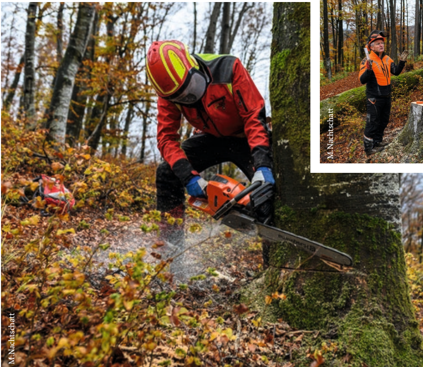
Die Schnittschutzhose schützt vor schweren Verletzungen mit der Motorsäge. Bei Kontakt mit der laufenden Sägekette werden größere Bündel der in der Hose eingearbeiteten langen Kunststofffasern herausgezogen, wickeln sich um das Antriebsrad der Kettensäge und blockieren dieses so in Bruchteilen von Sekunden.
