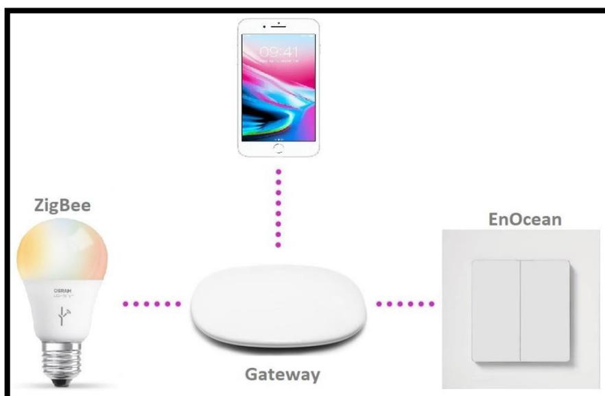
Abbildung 6: Schematische Darstellung Smart Home Gateway
