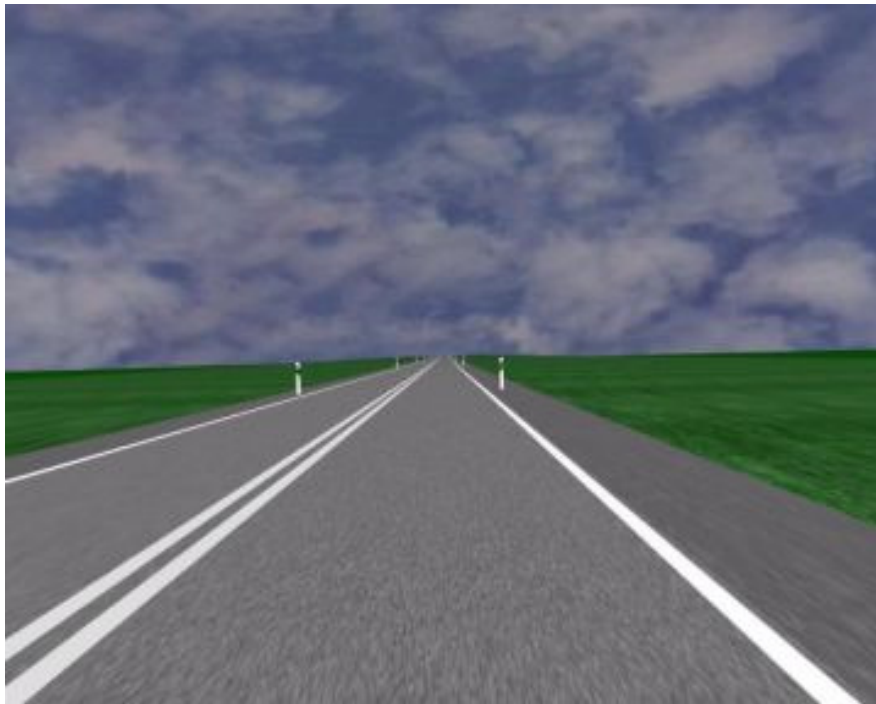
1+1 Straße, Fahrstreifenbreite 2,75 m doppelte Sperrlinie offener Straßenraum
