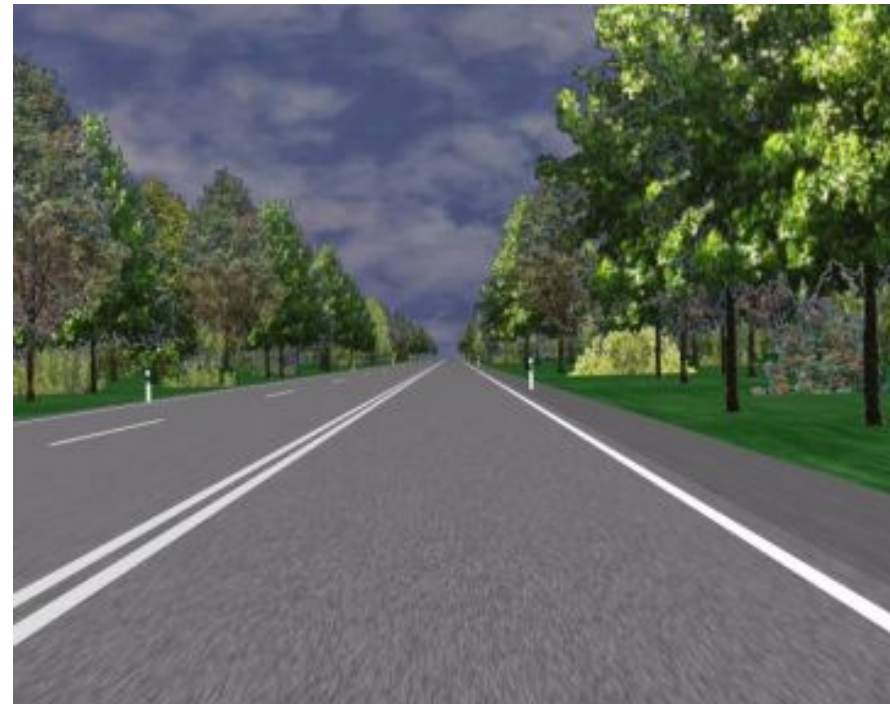
2+1 Straße, Fahrstreifenbreite 3,75 m doppelte Sperrlinie enger Straßenraum
